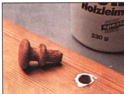
Расшатавшуюся ручку можно закрепить клеем ПВА, который имеет хорошую адгезию.
